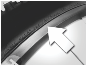
Tamanhos e níveis de pressão de ar no pneu
